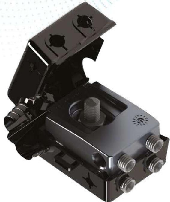
**Características:** conexiones de las derivaciones por sistema de apriete y conexiones del lado principal por sistema de perforación, sin la necesidad de pelar el cable. Tiene capa en formato cuña dispensando la herramienta de apertura de cables multiplexados para su instalación, permite conexiones bimetálicas.
