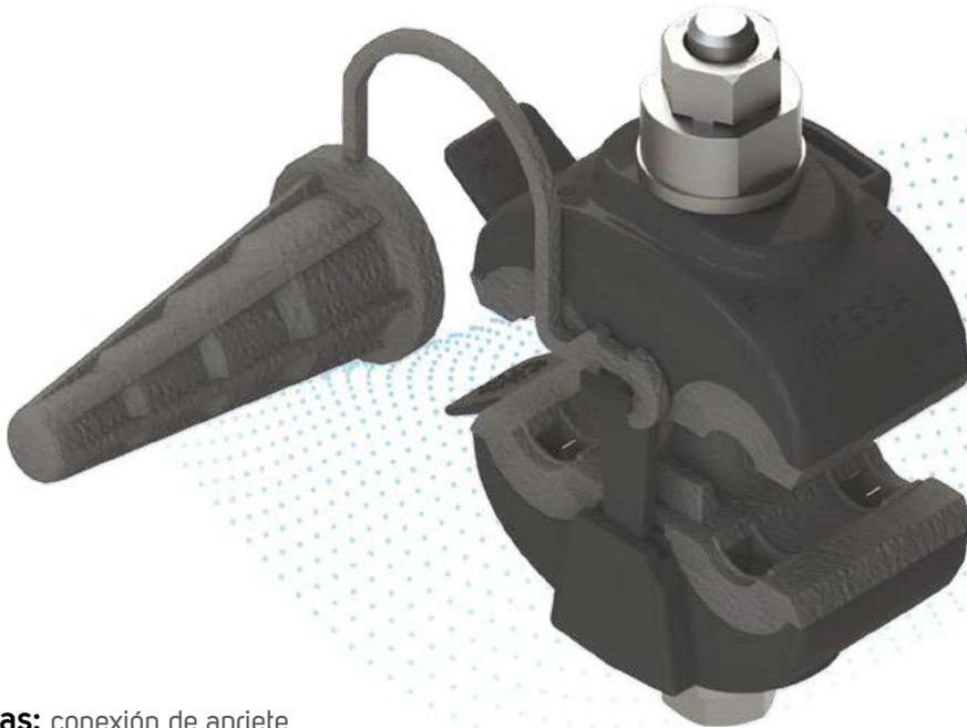
**Características:** conexión de apriete simultánea con tuerca fusible, a través de la perforación del aislamiento, asegurando la estanqueidad.
