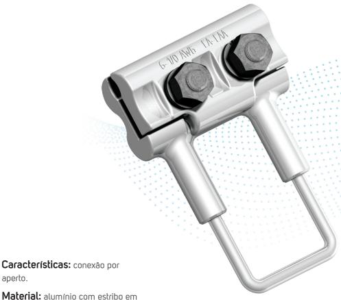
**Material:** alumínio com estribo em cobre estanhado, e parafusos, porcas e arruelas em aço zincado a fogo.
